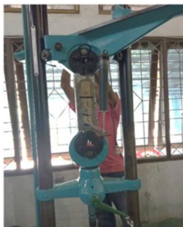
Gambar 2. Pengujian kuat lekatan antara beton dengan NFRP serat nenas
