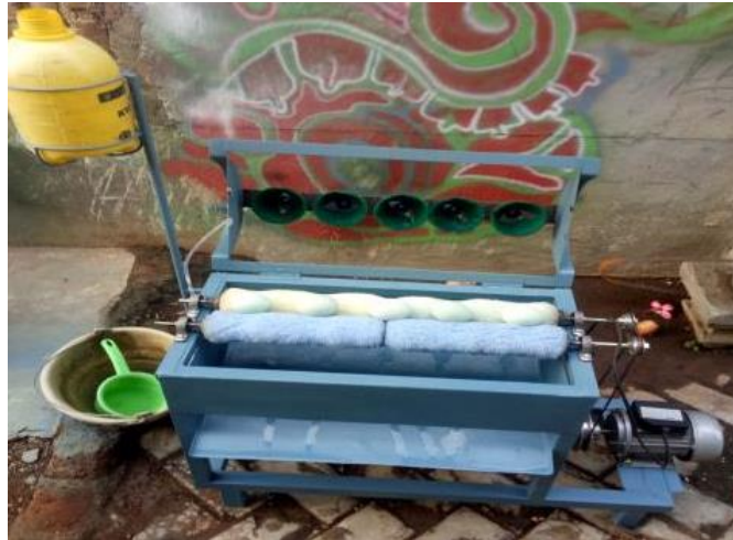
Gambar 2. Perakitan Komponen Mesin Pencuci Telur
