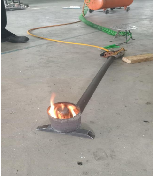
Gambar 1. Skema kompor oli bekas dengan blower selang dan sumbat kain
