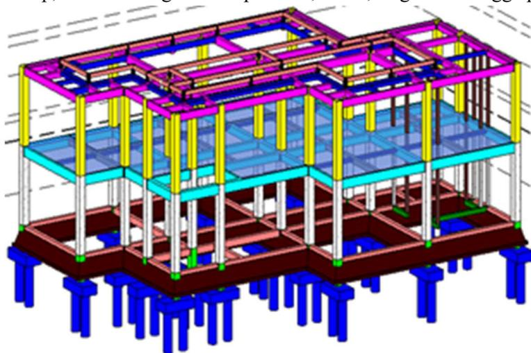
**Gambar 2:** Pemodelan struktur beton Gedung
