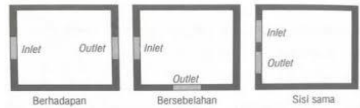
Gambar 1. Denah orientasi bangunan [8]
