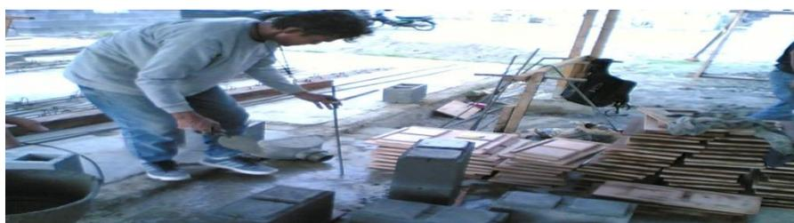
Gambar 4. Pembuatan beton hollow block
