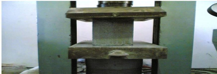
Gambar 3. Pengujian kuat tekan kubus beton Hasil pengujian kuat tekan kubus beton disajikan dalam Tabel 5. Hasil pengujian kuat tekan kubus beton hollow block (FAS 0,5), Tabel 6. Hasil pengujian kuat tekan kubus beton hollow block (FAS 0,5), dan Tabel 7. Hasil pengujian kuat tekan kubus beton normal (FAS 0,5).
