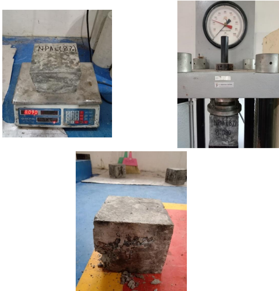
Gambar 3. Uji tekan beton
