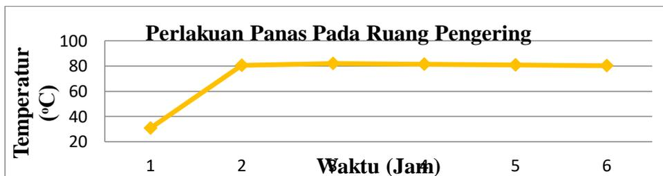
**Gambar. 3** Grafik Perlakuan Panas Didalam Ruang Pengering Pada Sample C
