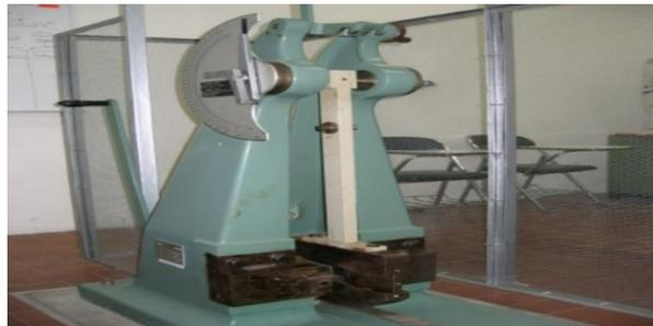
Gambar 3.2 mesin uji ketangguhan
