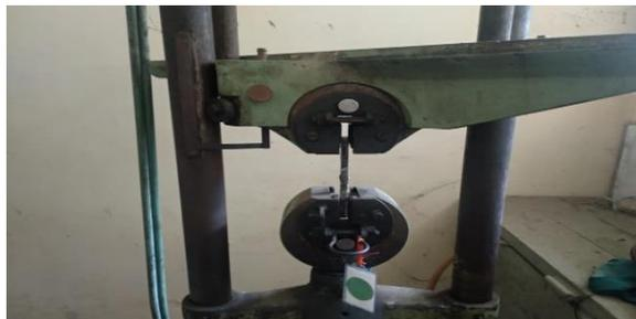
Gambar 3.1 Mesin uji kekuatan tarik
