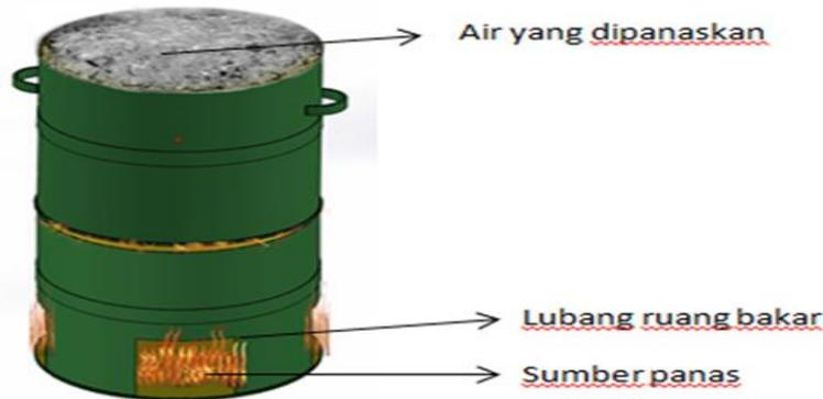
Gambar 3.1 Proses perebusan air
