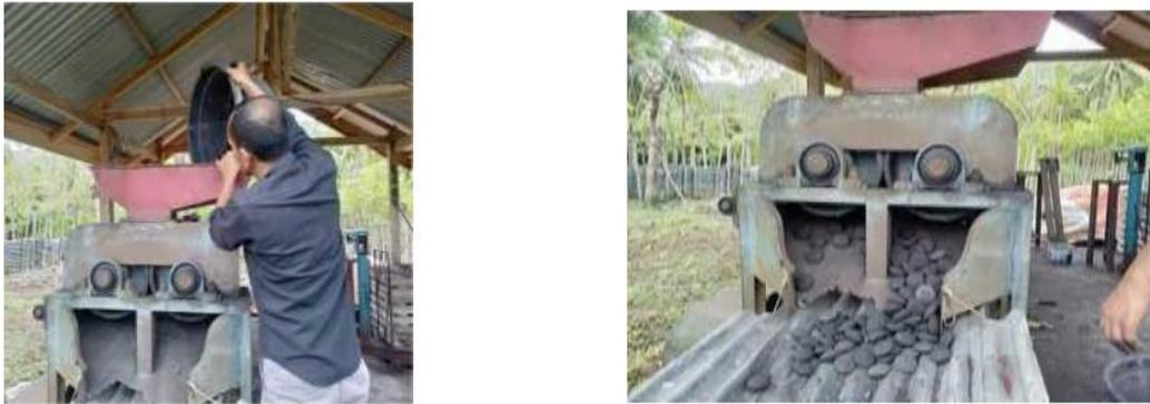
Gambar 3. Proses Proses Pengepresan dan Pencetakan
