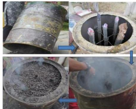
Gambar 1. Proses Pembakaran Cangkang Kelapa
