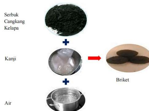
Gambar 2. Skema Pencampuran Serbuk Cangkang
