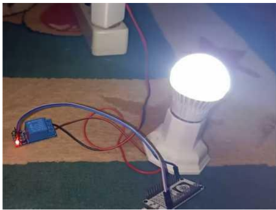
Gambar 11. Pengujian modul relay setelah dilalui arus listrik
